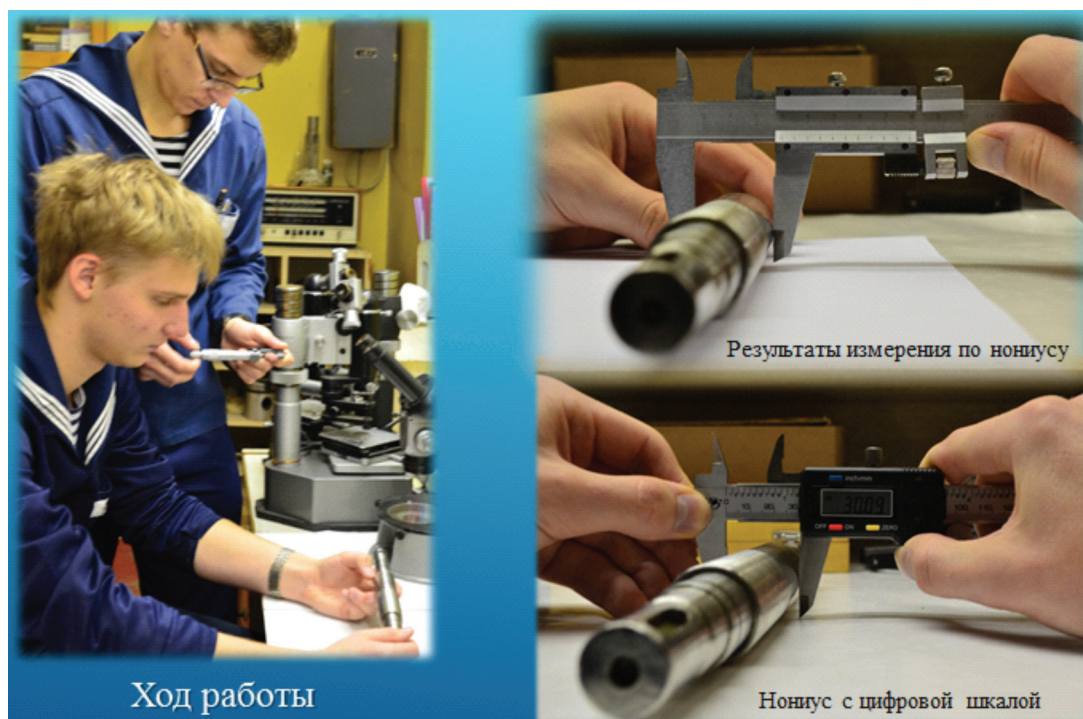
Рис. 1. Регистрация результатов линейных измерений по нониусу и электронному дисплею
