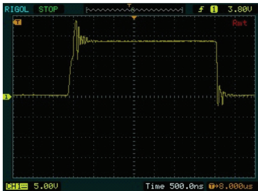
Рис. 3. Колебательные процессы в цепи затвора
