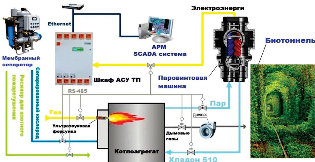
Рис. 4. Структурная схема автоматизированной систем управления противопожарной защиты мини-ТЭЦ
