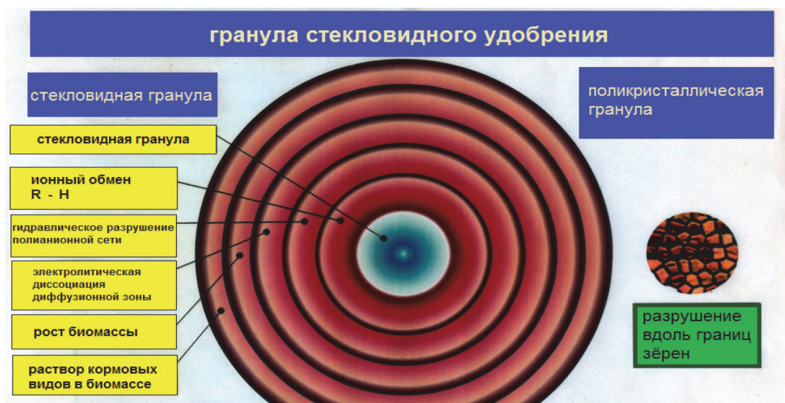
Рис. 1. Структура гранулы стекловидного удобрения
