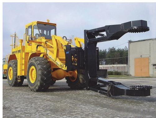
Фронтальный погрузчик Dressta с установленным на него шинным манипулятором
