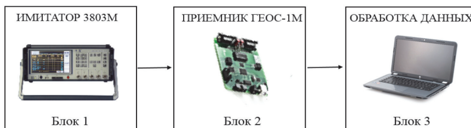
Рис. 3. Структурная схема программно-аппаратного комплекса для полунатурного эксперимента
