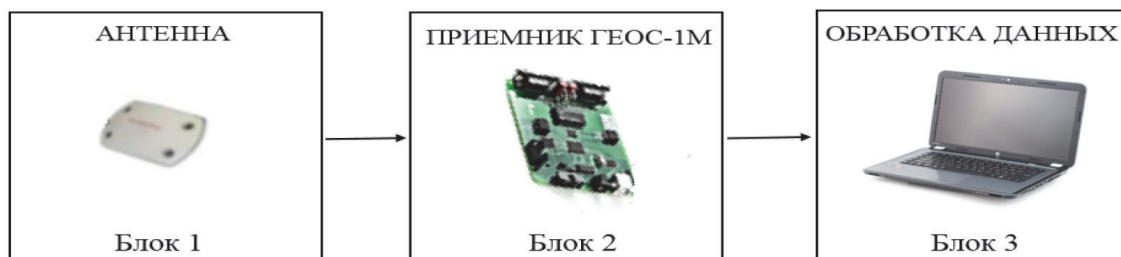
Рис. 2. Структурная схема программно-аппаратного комплекса для натурального эксперимента
