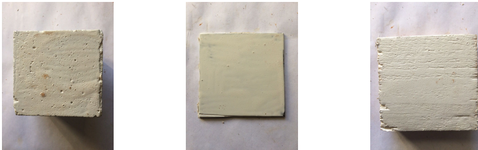
Рис. 4 Образцы окрашенных материалов после 40 часов нахождения в фотарии. (слева: бетон, металл, древесина)
