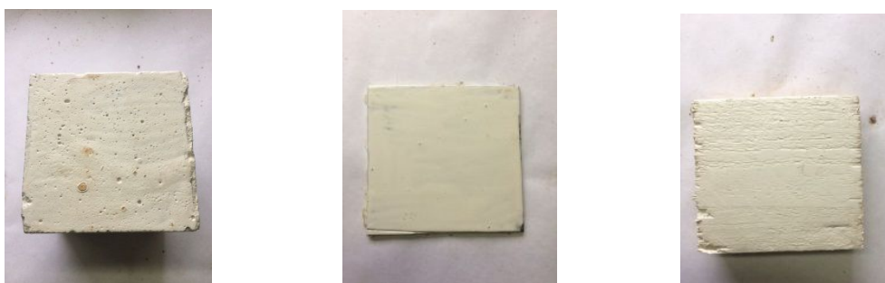
Рис. 1 Образцы окрашенных материалов после 10 часов нахождения в фотарии. (слева: бетон, металл, древесина)
