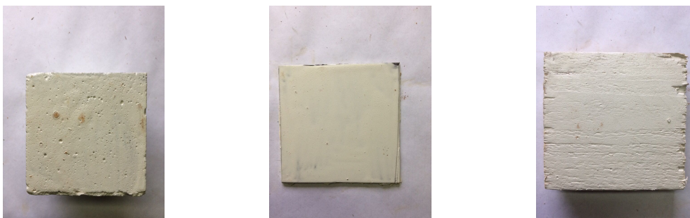
Рис. 3 Образцы окрашенных материалов после 30 часов нахождения в фотарии. (слева: бетон, металл, древесина)
