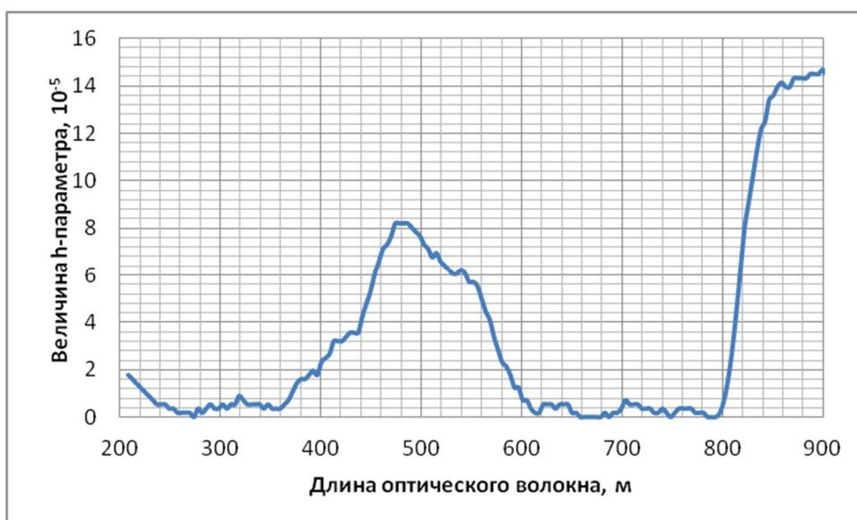
Рис. 1.3 – Зависимость  $h$ -параметра от длины анизотропного одномодового волокна типа Панда
