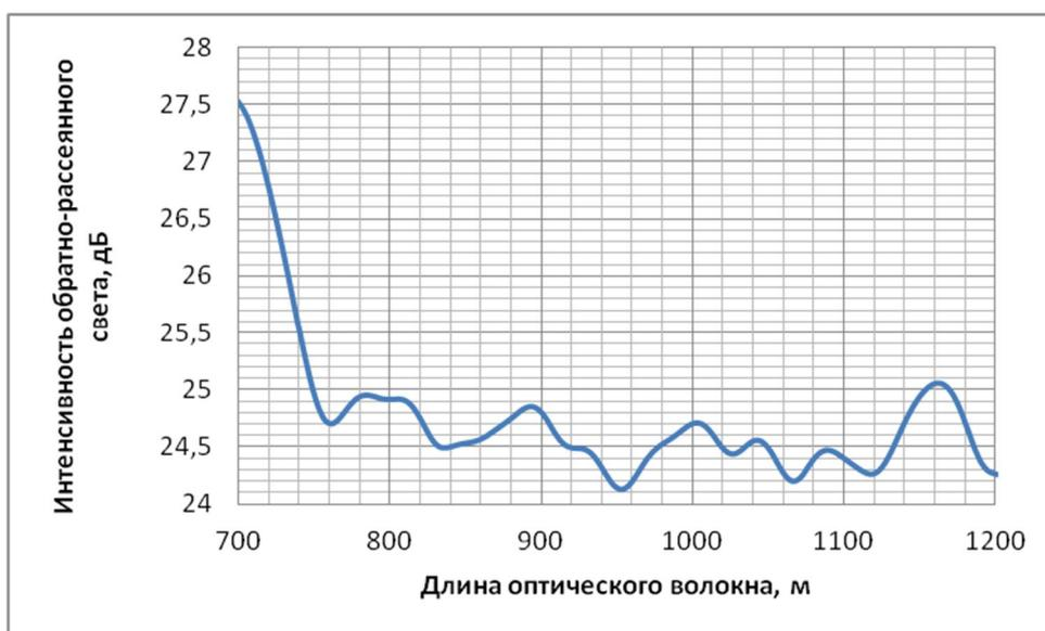
Рис. 3.1 – Характерный вид поляризационных биений, наблюдаемых в одномодовом изотропном оптическом волокне.
