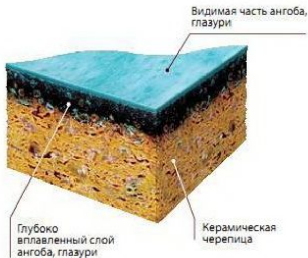
Рисунок – Структура бездефектного глазурного покрытия
