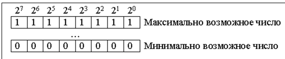
Рисунок 1. «Максимально и минимально возможное число в беззнаковом коде»
