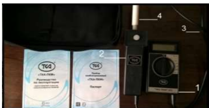
Рис. 5. Внешний вид прибора ТКА-ПКМ (43): 1 – Блок обработки сигналов; 2 – Фотометрическая головка; 3 – Кабель связи; 4 – Защитный колпачек.
