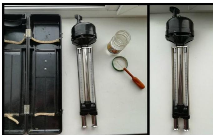
Рис. 4. Аспирационный психрометр МВ-4М
