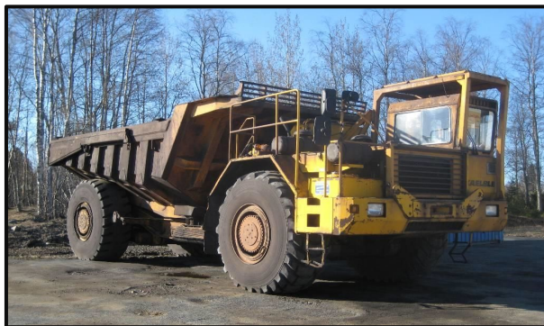
Рис.1. Карьерный шарнирно-сочлененный самосвал Kaebler kk50 [1,2].
