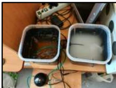
Рис.2. Гидропонная и аэропонная установки (слева направо)
