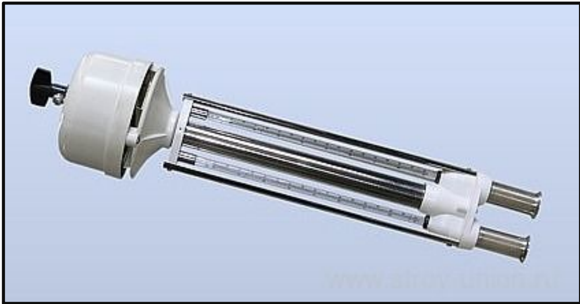
Рис. 3. Аспирационный психрометр МВ-4М
