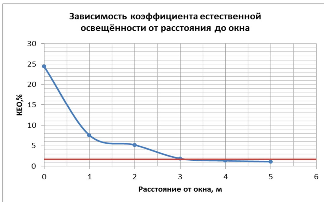
Рис. 6. График зависимости коэффициента естественной освещённости от расстояния до окна
