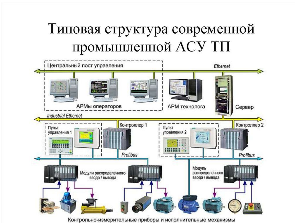
Рисунок 3 – Типовая структура современной промышленной АСУ ТП
