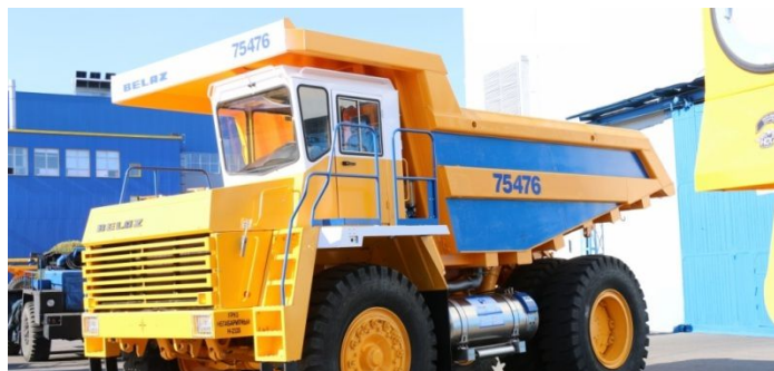
Рис. 2. БЕЛАЗ-75476 оборудованный газопоршневым двигателем внутреннего сгорания Для БелАЗ 75473 (рис.4):
