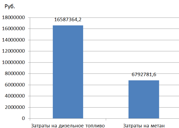
Рис. 4. Затраты на топливо дизельной и газомоторной модификации автомобиля БелАЗ за сутки
