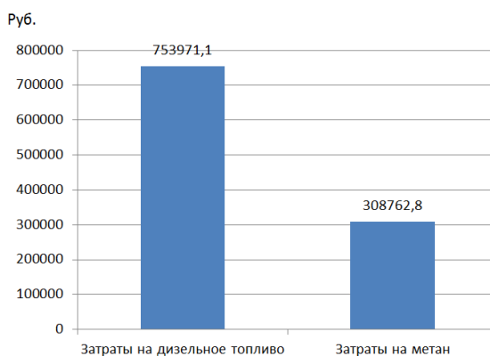
Рис. 5. Затраты на топливо дизельной и газомоторной модификации автомобиля БелАЗ за год
