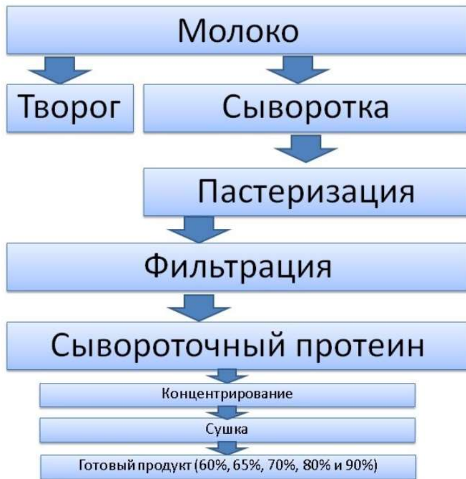
Рисунок 1 - Схема производства протеина
