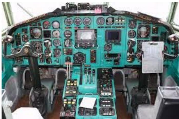
Рис. 1. Размещение аппаратуры АБСУ на самолете Ту-154
