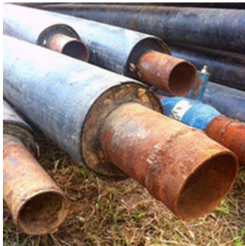
Рисунок 2 - Трубы, произведённые в соответствии с требованиями ГОСТ 30732-2006, после нескольких лет эксплуатации.
