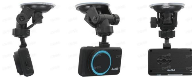
Рисунок 1. Прибор контроля усталости водителя за рулем.
