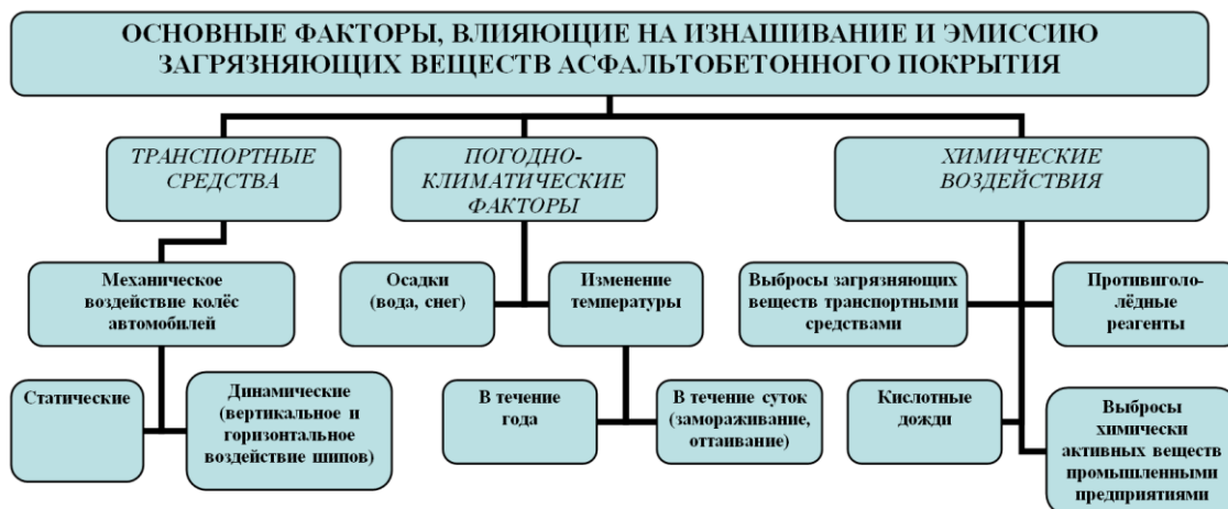
Рисунок 1 – Основные факторы, влияющие на изнашивание и эмиссию загрязняющих веществ асфальтобетонного покрытия
