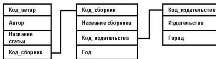
Рисунок 3 – Пример реляционной модели данных
