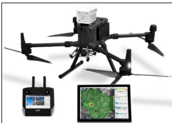
Рисунок 1 – Общий вид БПЛА для экологического мониторинга с передвигением БПЛА детектором Sniffer4 V2.0
