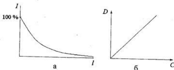
Рис. 1 Кривая интенсивности светового потока в зависимости от толщины слоя вещества (а); зависимость оптической плотности от концентрации раствора (б)
