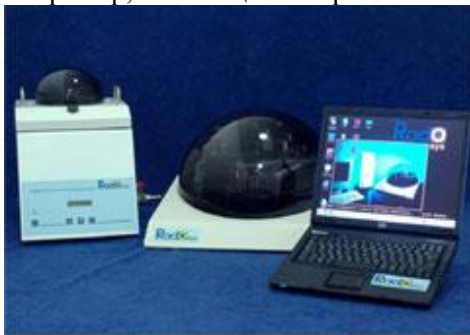
Рис. 2. SISTEMA RADOSYS RSV6. Лабораторный комплекс для интегрального измерения радона.
