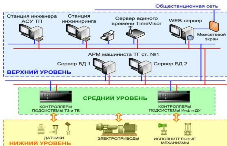
Рисунок 1 – Автоматизированная система управления
